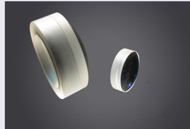
胶合透镜也叫消色差透镜，是由两个单片镜片通过胶合而成，在复色（白光）成像的性能比单透镜性能提高了许多。消色差镜片由两片材料不同的镜片胶合在一起，校正了玻璃的色散。消除了色差问题，消色差镜片就在多色照明以及成像方面得到了广泛的应用，提高了成本效益。
